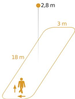
Possibile altezza di montaggio: 2,50 m - 3,50 m
